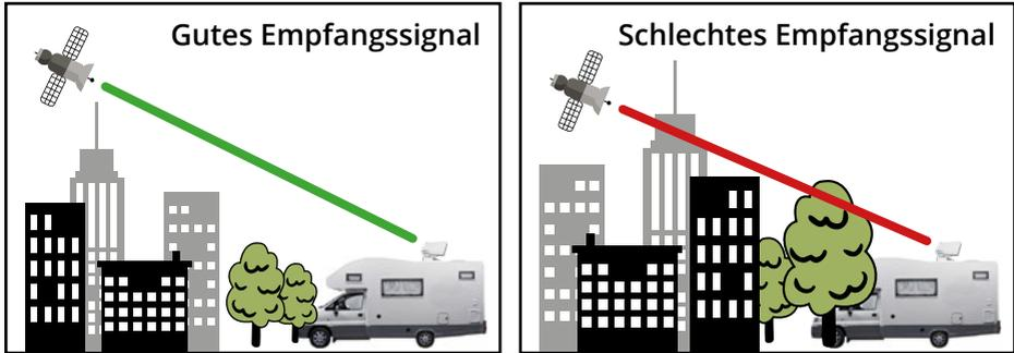
Objekte wie Bäume, Brücken und große Häuser, die sich im Einfallswinkel des Satelliten befinden, führen zu einem Verlust des Signals. Starker Regen, Wolken, Schnee oder Eis kann die Empfangsqualität beeinträchtigen. Wenn das Satellitensignal durch schwere Wetterbedingungen verloren geht, wird das laufende Programm des Receivers beendet (das Bild wird einfrieren, bzw. verschwinden). Wenn die Witterungsverhältnisse wieder einen guten Empfang ermöglichen, wird das TV Bild wieder hergestellt.
