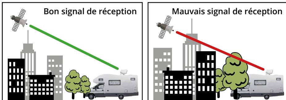
Des obstacles comme des arbres, des ponts et grands bâtiment, qui se trouvent dans l'angle d'incidence du satellite, induisent une perte du signal. Des pluies fortes, nuages, neiges ou glaces peuvent altérer la qualité de réception. Si le signal du satellite est perdu à cause des conditions climatiques, le programme actuel du récepteur est arrêté (l'image va geler ou disparaître). Si les conditions atmosphériques permettent de nouveau une bonne réception, l'image sera restaurée.
